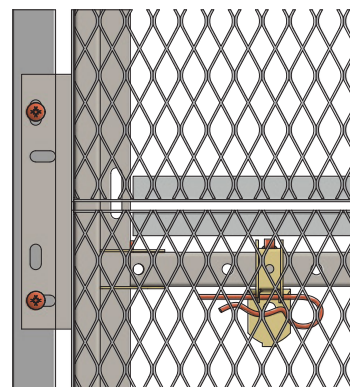
Deckenuntersicht, Wandabschluss mit offener Fuge Widok dolny, przyłączenie do ściany z otwartą szczeliną
