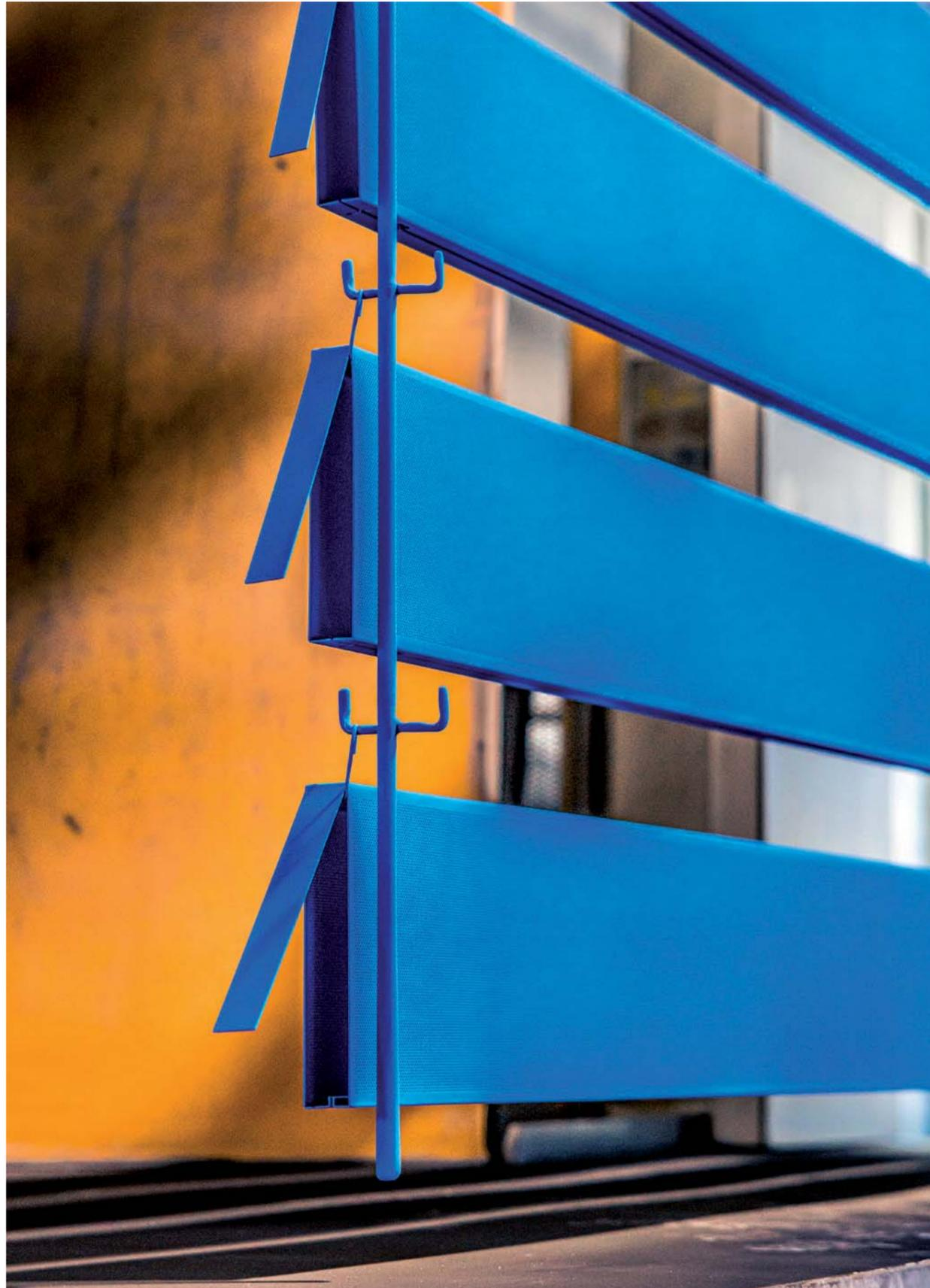
Auf einer Pulverlackierungsstraße mit hängendem Transport der Bauteile durch die Lackier- und Brennkammer bekommen die Baffeln ihre endgültige Oberfläche in gewünschter Farbe, Schichtstärke sowie Mattheits- oder Glanzgrad.
