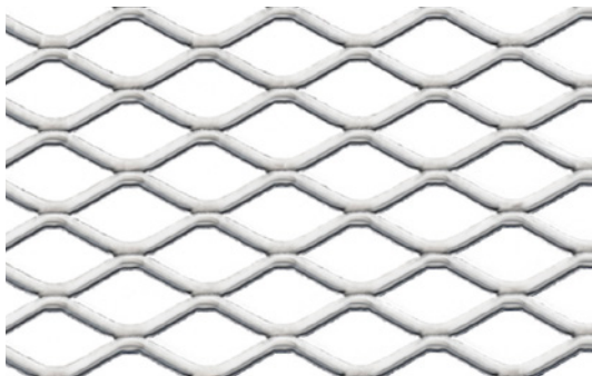
Masche 22 x 12 x 2,0 x 1,5 [mm] Oczko freier Querschnitt ca. 66,7% prześwit względny
