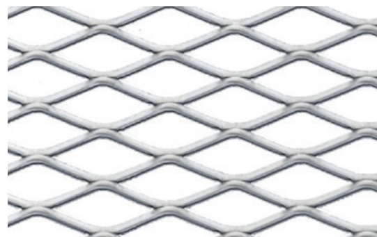
Masche 30 x 12 x 2,0 x 1,5 [mm] Oczko freier Querschnitt ca. 66,7% prześwit względny
