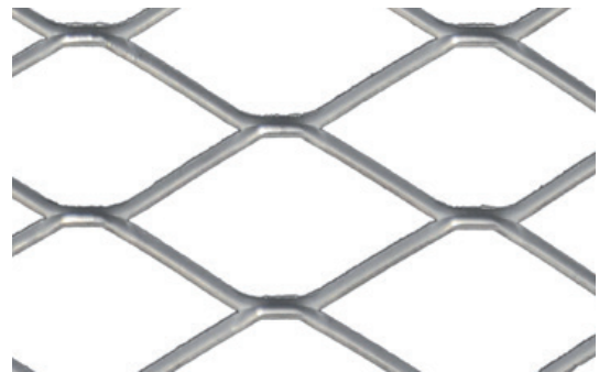
Masche 60 x 32 x 3 x 1,5 [mm] Oczko freier Querschnitt ca. 81,3% prześwit względny
