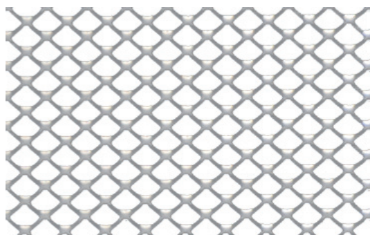
Masche 10 x 7,5 x 1,5 x 1,0 [mm] Maille freier Querschnitt ca. 60% section libre env.
