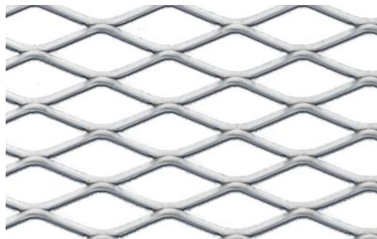
Masche 30 x 12 x 2,0 x 1,5 [mm] Maas freier Querschnitt ca. 66,7% vrije doorlaat ca.
