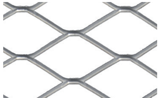
Masche 60 x 32 x 3 x 1,5 [mm] Maille freier Querschnitt ca. 81,3% section libre env.
