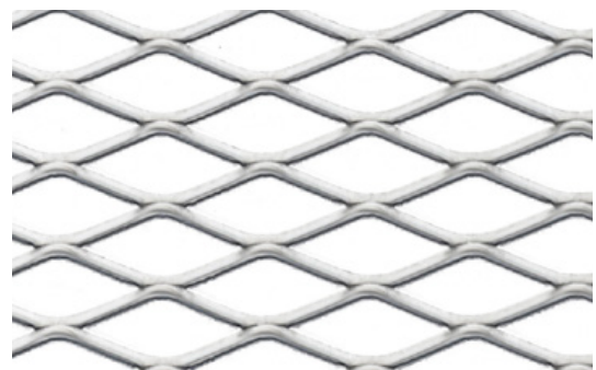
Masche 30 x 12 x 2,0 x 1,5 [mm] Maille freier Querschnitt ca. 66,7% section libre env.
