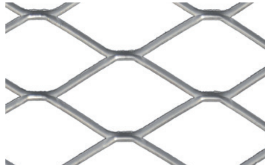
Masche 60 x 32 x 3 x 1,5 [mm] Maglia freier Querschnitt ca. 81,3% sezione libera ca.
