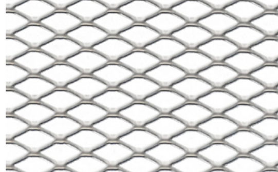
Masche 16 x 8 x 1,5 x 1,0 [mm] Maas freier Querschnitt ca. 62,5% vrije doorlaat ca.
