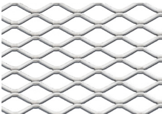
Masche 22 x 12 x 2,0 x 1,5 [mm] Maille freier Querschnitt ca. 66,7% section libre env.
