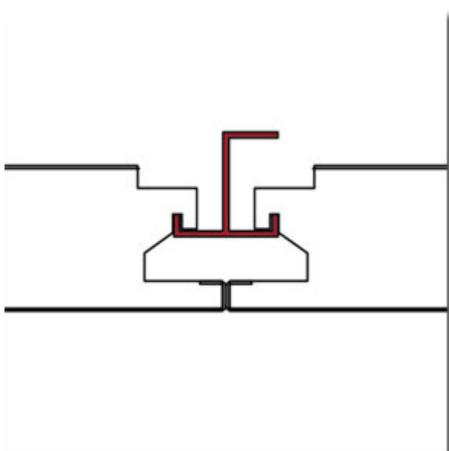
Im Zuge der bevorstehenden Überarbeitung des FURAL-Deckenhandbuchs wird das System **KLH-H28** als **Standardsystem** für Akustikdecken in das Lieferprogramm mitaufgenommen. Die zentralen Komponenten sind Kreuzverbinder, mit denen das H-Tragprofil am Rostwinkel befestigt wird. Die Metallkassetten werden stirnseitig in das H-Profil eingehängt.
