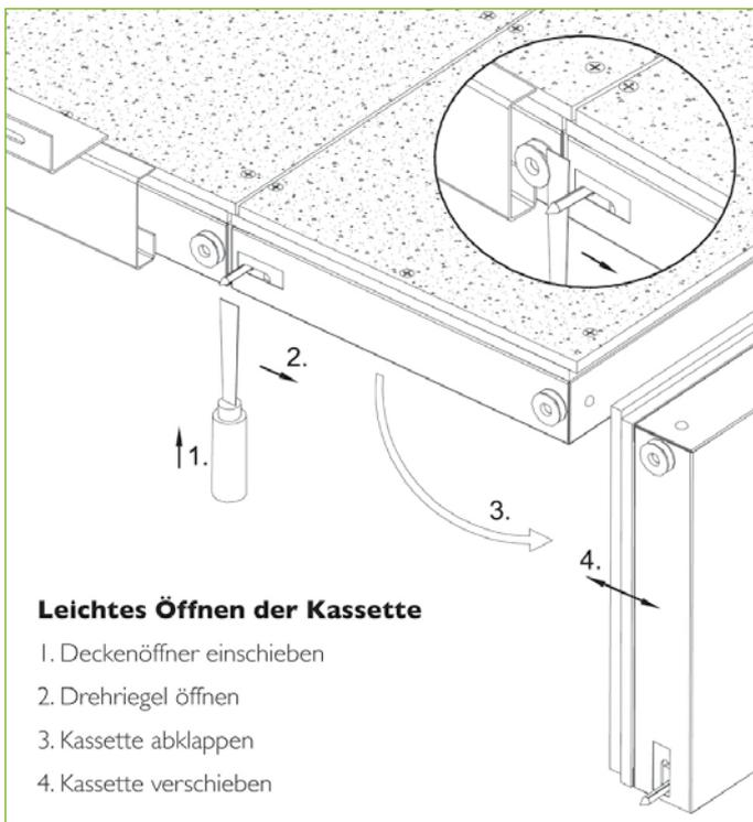
fe um kurzfristig einen optimalen Brandschutz zu realisieren. Die LED-Beleuchtung ist bereits in die Brandschutzdecke integriert. Das intelligente Abklappsystem erleichtert Wartungsarbeiten zudem enorm. Egal ob Strom-, Netzkabel oder Datenleitungen geprüft werden müssen, dank der
