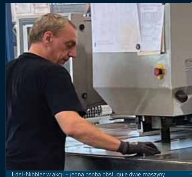
Edel-Nibbler w akcji – jedna osoba obsługuje dwie maszyny.
