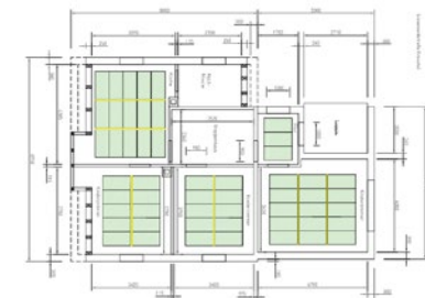
Flächenheizung aus Metall mit Platten 600x1200, Zusatzfunktion Kühlung im Sommer
