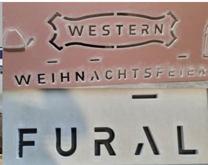
Frezarka - wycięcia w płycie gipsowo-kartonowej; możliwe materiały: drewno, płyta gipsowo-kartonowa, płyta wiórowa, Fermacell itp.
