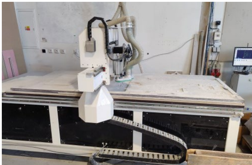
Frezarka - wycięcia w płycie gipsowo-kartonowej; możliwe materiały: drewno, płyta gipsowo-kartonowa, płyta wiórowa, Fermacell itp.
