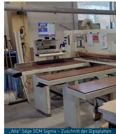
„Alte“ Säge SCM Sigma – Zuschnitt der Gipsplatten
