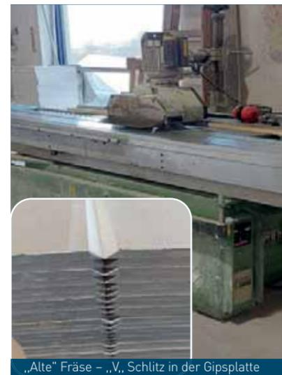
„Alte“ Fräse – „V“ Schlitz in der Gipsplatte
