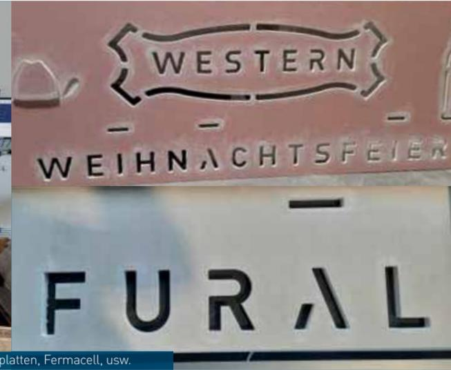
„Neue“ Fräse – Ausschnitte in der Gipsplatte; mögliche Materialien: Holz, Gipsplatten, Spanplatten, Fermacell, usw.
