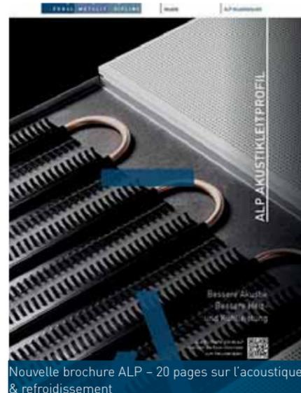
Afin d'améliorer les propriétés acoustiques, les lattes sont partiellement pliées. Cela améliore l'acoustique mais aussi les propriétés thermiques. En pliant les ailettes, la surface de l'échangeur de chaleur dans la cavité de la cassette augmente. De plus, les lattes courbées optimisent le transfert convectif.
