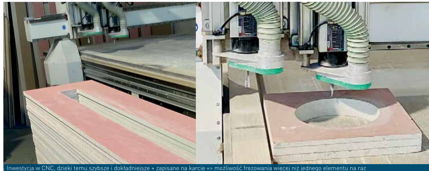
Inwestycja w CNC, dzięki temu szybsze i dokładniejsze + zapisane na karcie => możliwość frezowania więcej niż jednego elementu na raz
