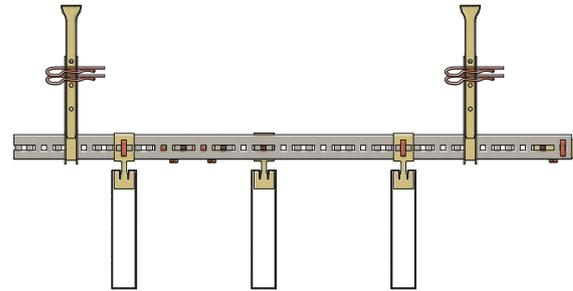
Baffel-Kreuzverbinder werden durch drehen in der Baffel eingebaut und sind mit einem Steck Clip im C20-Profil zu sichern.
