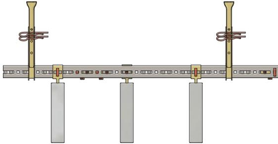
Durch diagonal versetzte Montage der Baffel-Kreuzverbinder wird das C20-Profil gleichmäßig belastet.
