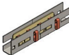
C20-Profile können mit dem C20-Längsverbinder endlos verlängert werden. Der Längsverbinder wird in jedem C20-Profil mit zwei diagonal montierten Steck Clips gesichert und von unten mit zwei M6-Schrauben verschraubt.
