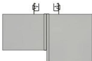
Unterschiedliche Baffelhöhen können in einer Flucht und mit Nullabstand montiert werden.
