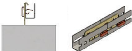
Steck-Clips sind mit dem langen Federschenkel nach oben (offene C20-Profilseite) zu montieren. Liegen zwei quadratische Ausklinkungen übereinander, kann der Steck Clip auch um 90° verdreht montiert werden. So sind sie wieder einfach ohne Werkzeug demontierbar.
