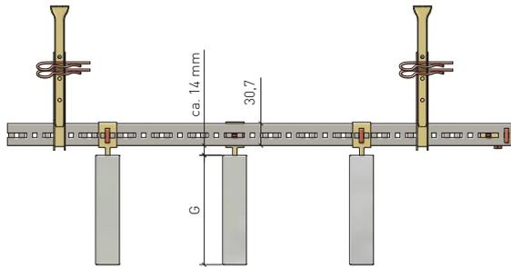
Die Abhanghöhe von der Oberkante der Baffel zu der Unterkante des C20-Profiles beträgt ca. 14 mm. Das C20-Profil ist 30,7 mm hoch.
