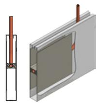
Einteilige Baffeln können thermisch aktiviert werden und tragen somit maßgeblich zum Komfort im Gebäude bei. Les baffles en une pièce peuvent être activés thermiquement et ainsi contribuer de manière significative au confort dans le bâtiment.
