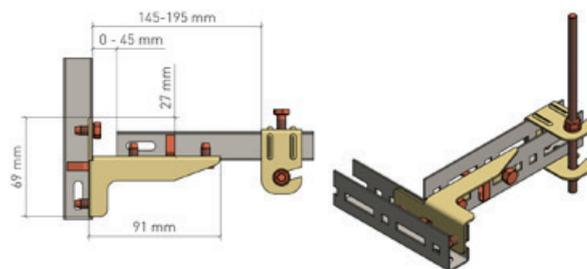
Mit dem T-Verbinder lassen sich 90°-Stöße von C20-Profilen bei der Montage leicht realisieren und verbinden. Sie dienen nicht der Lastübertragung! Sicherung erfolgt mittels Steck Clips und 6,3mm Blechschräuben. Nächster Abhänger muss mit max. 195 mm zum C20-Stoß montiert werden.
