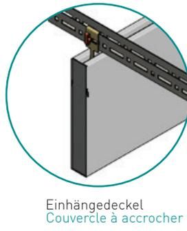
Baffelenden können mit Einhäng- oder Aufschiebendeckel geschlossen werden. Gezeigter Deckel: Einhängendeckel. Bei Einhängendeckel besitzen beide Enden Ausklinkungen, um die Deckel einhängen zu können. Diese Ausklinkungen sind beim einteiligen Baffelverbinder sichtbar. Beim Aufschiebendeckel sind diese Ausklinkungen nicht notwendig.
