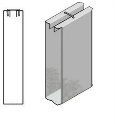
Ab einer Baffellänge von 2,5 m wird ein Bügel in der Mitte der Baffel eingesetzt. Dazu wird die Baffel etwas zusammengedrückt, um den Baffelbügel einzuhängen.
