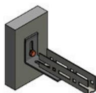
Zur stirnseitigen Wandmontage von C20-Profilen wird der Wandwinkel verwendet. Dieser erlaubt einen Wand/C20-Profil-Abstand von 0-55 mm. Es ist sicherzustellen, dass die M6-Verschraubung nicht in angeschnittenen Langlöcher oder Bohrungen gemacht wird.
