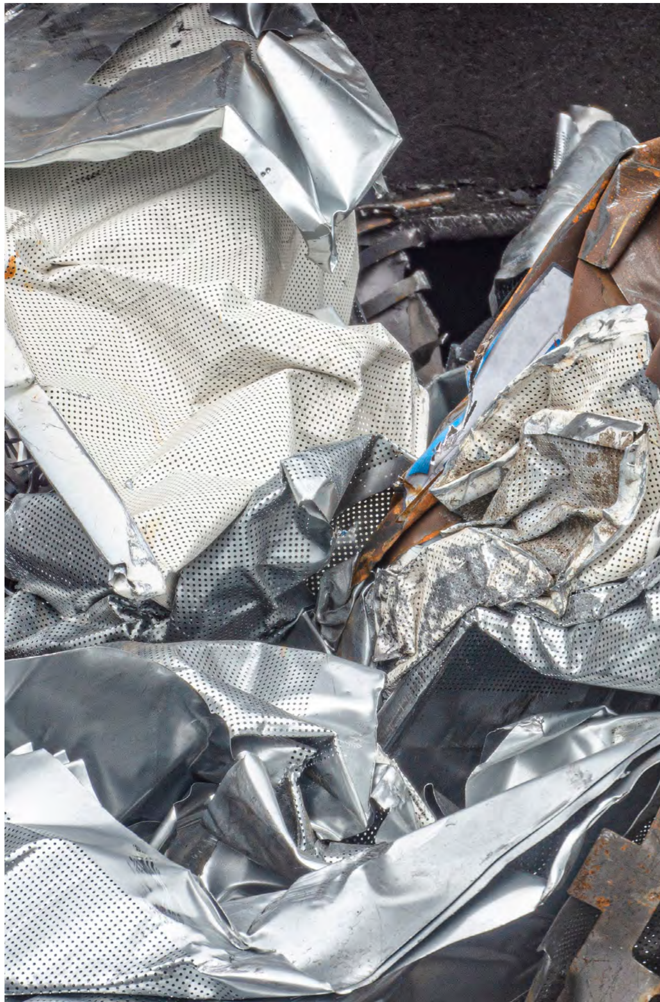
I controsoffitti in metallo sono un prodotto sostenibile. Il metallo può essere fuso un numero infinito di volte e recuperato nel processo di riciclaggio stabilito.
