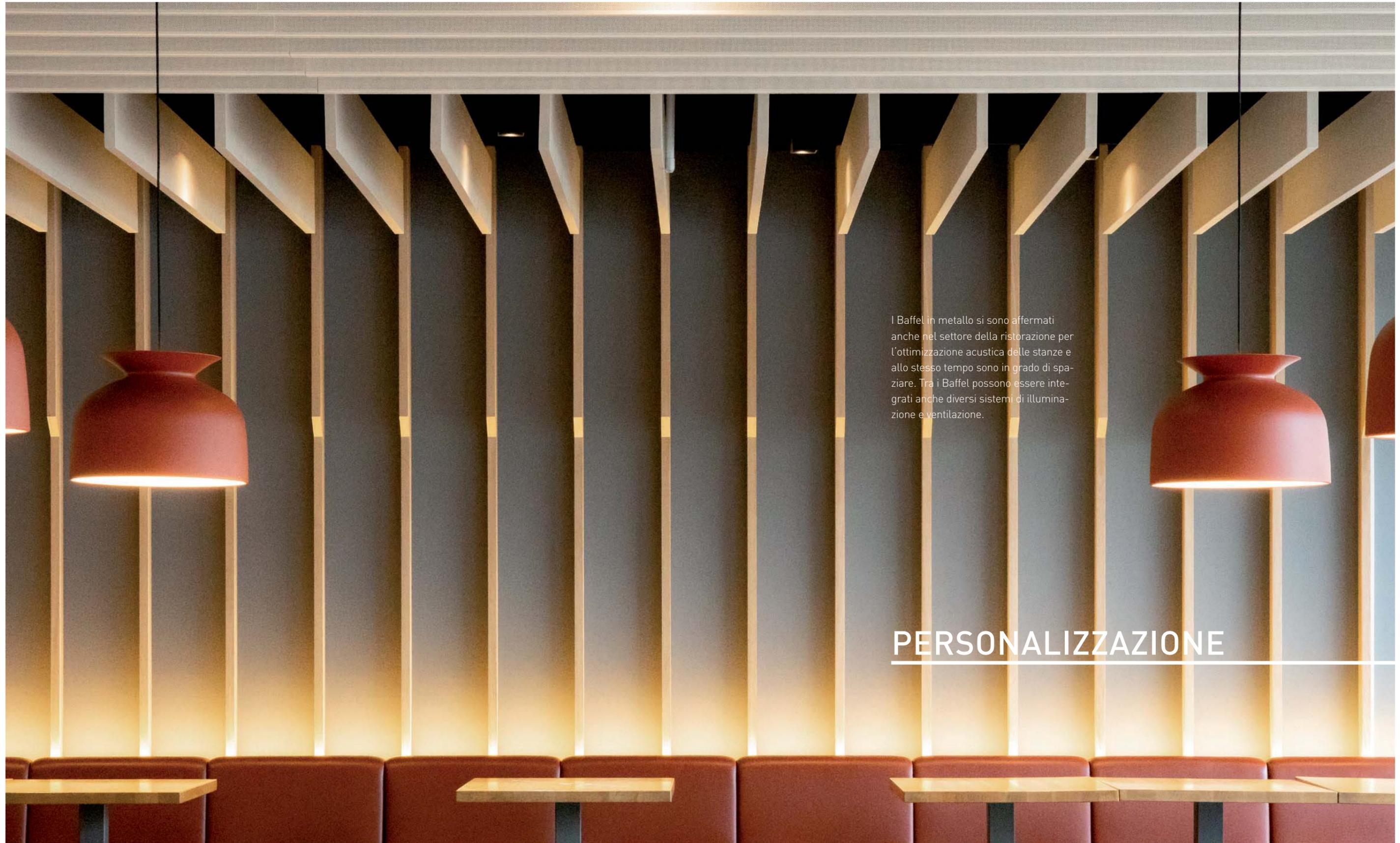
I Baffel in metallo si sono affermati anche nel settore della ristorazione per l'ottimizzazione acustica delle stanze e allo stesso tempo sono in grado di spaziare. Tra i Baffel possono essere integrati anche diversi sistemi di illuminazione e ventilazione.
