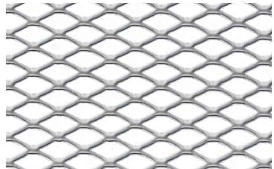
Masche 16 x 8 x 1,5 x 1,0 [mm] Maglia freier Querschnitt ca. 62,5% sezione libera ca.
