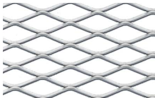
Masche 30 x 12 x 2,0 x 1,5 [mm] Maille freier Querschnitt ca. 66,7% section libre env.
