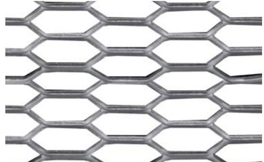
Masche 44 x 10 x 2 x 1,5 [mm] Maille freier Querschnitt ca. 60,0% section libre env.
